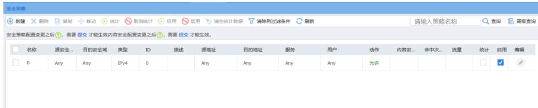
如上图所示，本地测试是全放通策略，所以不存在安全策略阻断的问题。如果现场的安全策略配置十分明细且复杂，建议在 ping 测试结果中打开调试开关。
