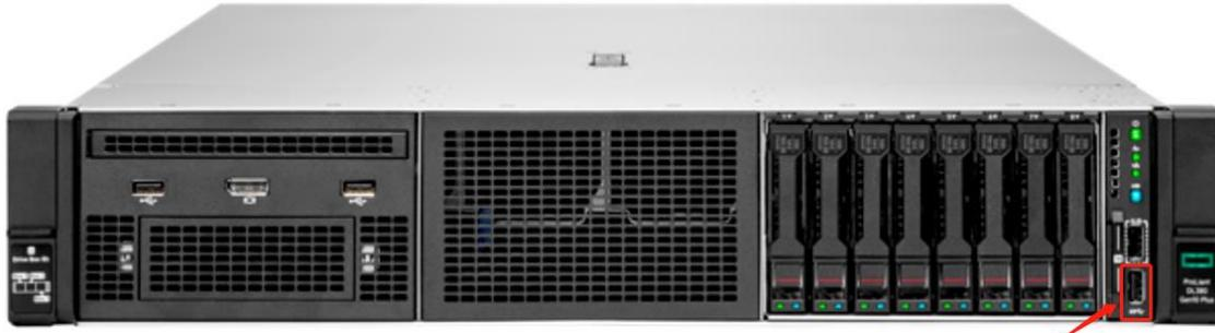
注：请勿将启动 U 盘连接到虚框标识的 iLO USB 服务接口。引导 U 盘的可用接口标识为  $\leftarrow$  和  $\rightarrow$ 。
