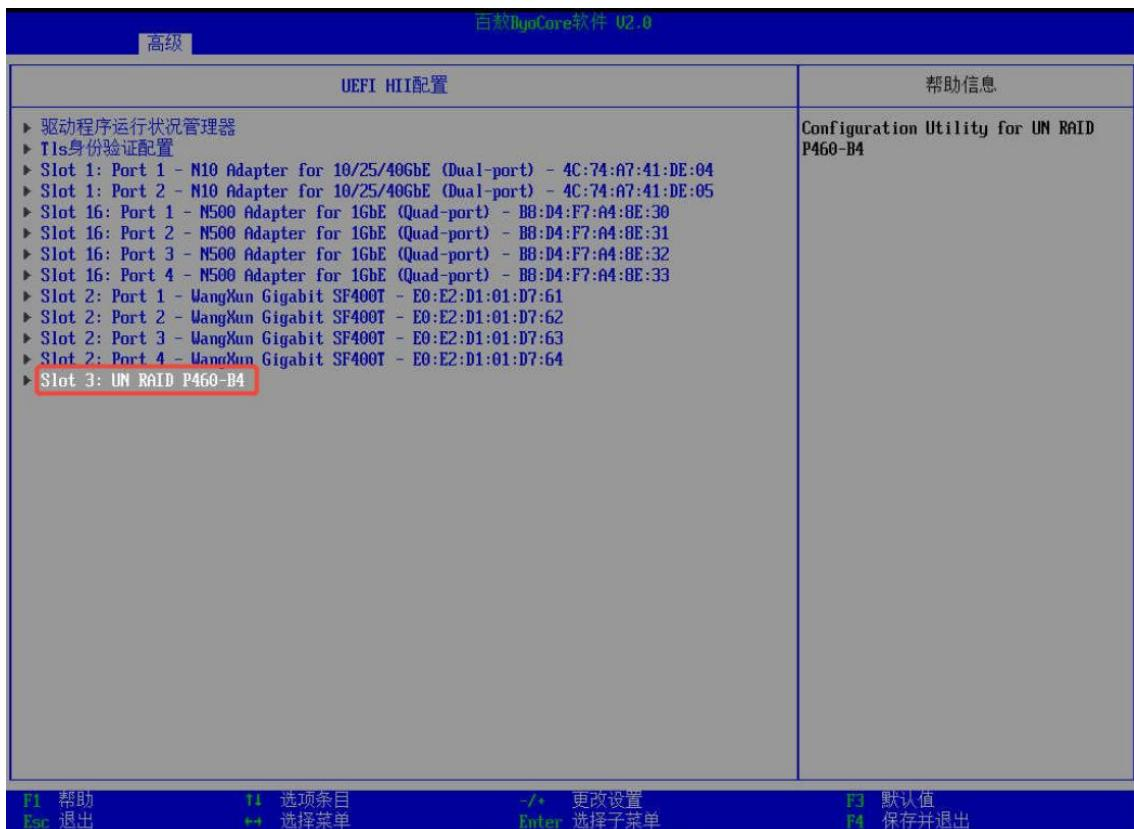
3) 依次选择配置控制器设置>配置控制器端口模式>设置控制器模式<混合>设置阵列卡的工作模式。
