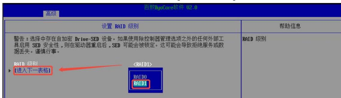
6) 在逻辑硬盘标签、条带大小/完整条带大小、大小、单元大小和 SSD 过度配置优化、加速方法栏进行相应的设置，然后选择[提交更改]，按 Enter。
