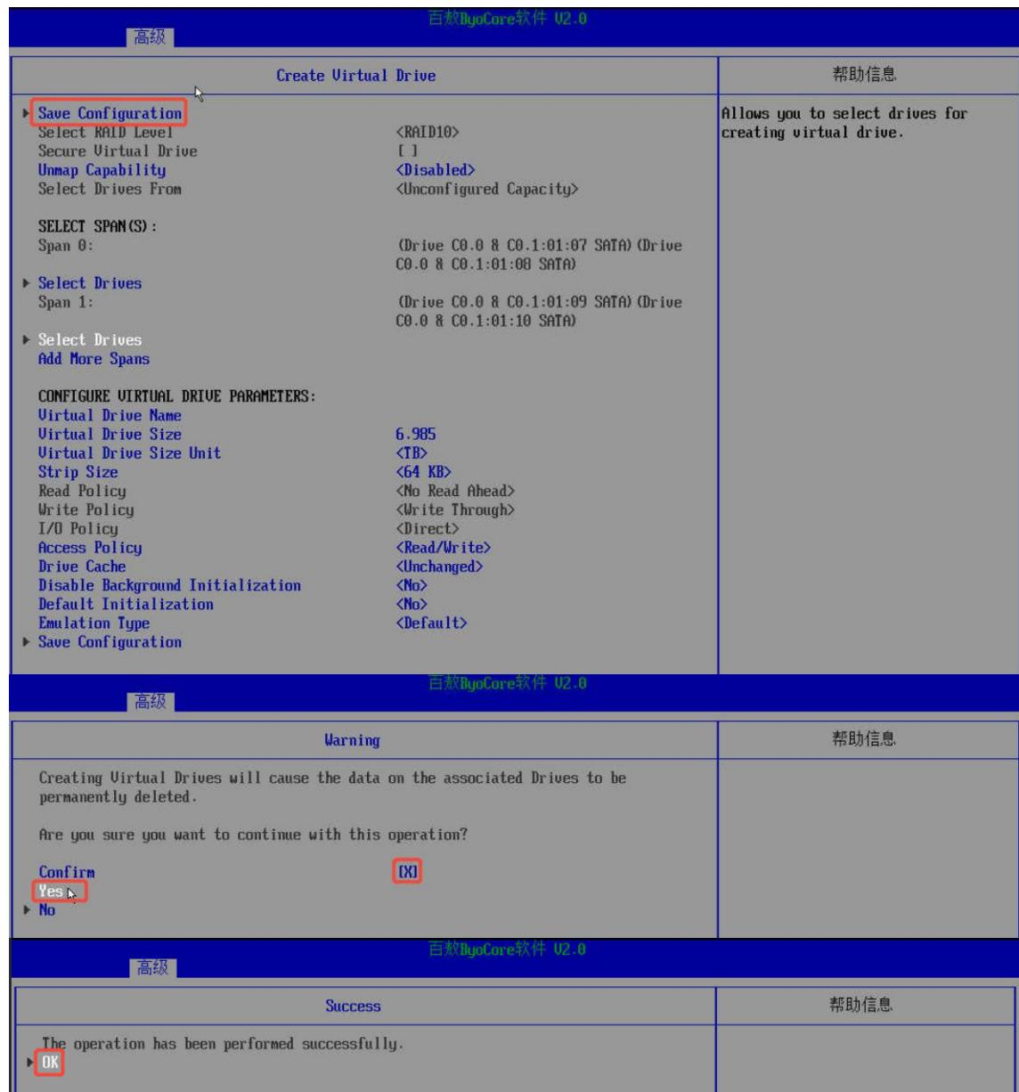
注： RAID 10 支持 2~8 个 Span，每个 Span 至少需要 2 个磁盘且数量必须为偶数，且各个 Span 的硬盘数量必须保持一致。
